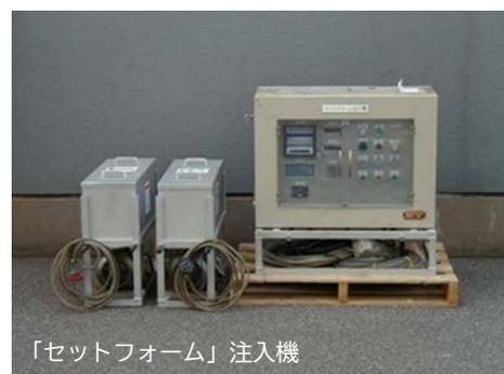
「セットフォーム」はHF0を発泡剤として使用し、かつ耐熱性の高いイソシアヌレート結合を有することで、発泡時の反応熱上昇の抑制と高い耐熱温度を両立し、大空洞施工時の発煙事故を防止します。
